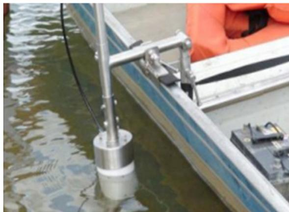
Figura 7 Perfilador Acústico Doppler, acoplado ao barco.
