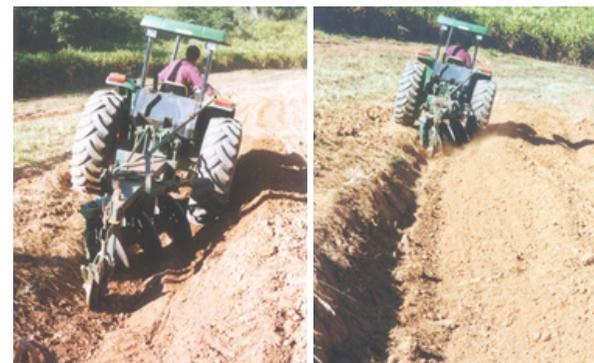
**Figura 36** Posicionamento do trator com rodas de cima passando acima do corte (pequeno talude), promovendo o aprofundamento do canal.
