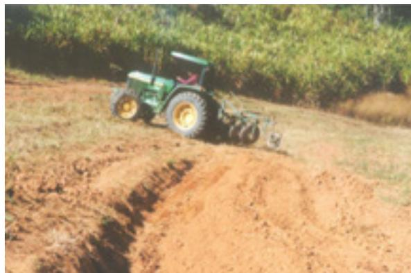
**Figura 34** Reversão do arado e manobra do trator para retornar na segunda passada.
