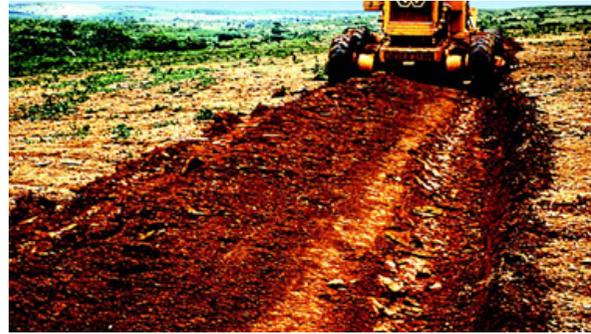
Figura 41 Motoniveladora sendo empregada na construção de terraços.
