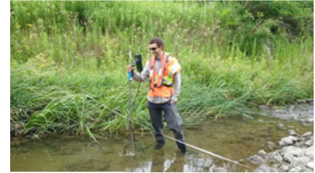
Figura 3 Perfilador acústico *Velocimeter* e medição de vazão a vau em rios. Fonte: SonTek (2009).
