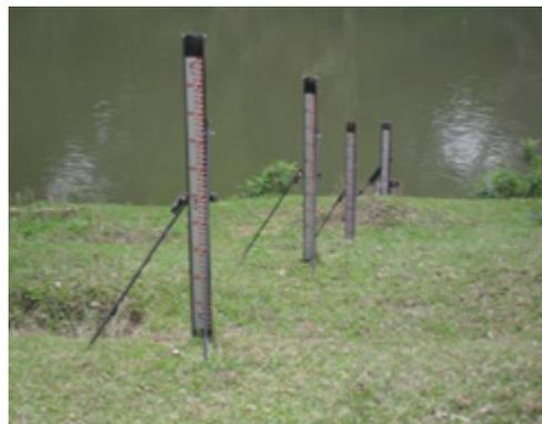
**Figura 13** Réguas linimétricas instaladas segundo os padrões ANA. Fonte: ANA, (2016).
