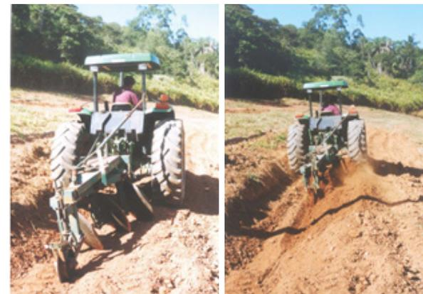
**Figura 35** Posicionamento do trator com rodas dentro do sulco, promovendo a abertura do canal.
