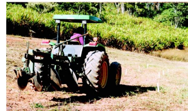
**Figura 25** Trator posicionado com a face interna da roda tocando as estacas na parte de cima da ilha para iniciar a construção do terraço de base larga.
