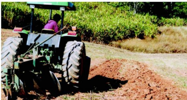
**Figura 27** Trator posicionado com a roda dentro do sulco de aração, para a segunda passagem da primeira série.
