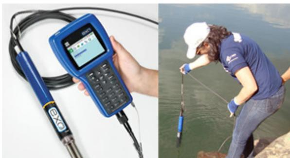
**Figura 15** Sonda multiparâmetros portátil para medição de parâmetros de qualidade de água.
