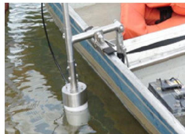
Figura 9 Perfilador Acústico *Doppler*, ancorado em cabo de aço e acoplado ao barco.
