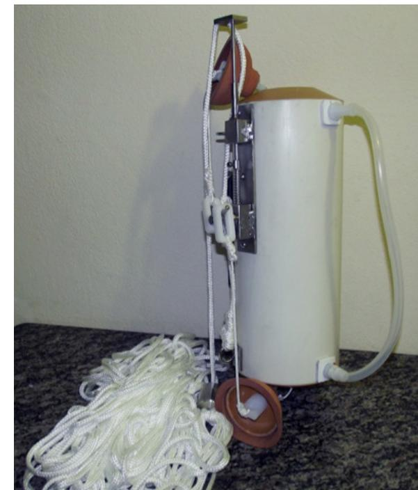
Figura 4 Amostrador de sedimento em suspensão, Garrafa de Van Dorn.
