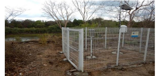
Figura 10 Plataforma de coleta de dados com sistema automático de aquisição e transmissão de dados por telemetria.
