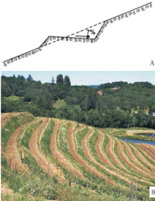
**Figura 9** Seção transversal típica do terraço do tipo patamar (A) e sua aplicação em vinhedo, com taludes protegidos com vegetação (B). Fonte da foto B: Disponível em: <<http://photo-gallery.nrcs.usda.gov/>>.
