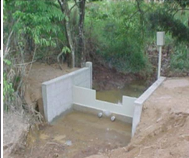
Figura 2 Vertedores triangular e retangular para medição de vazão em pequenos cursos d'água.
