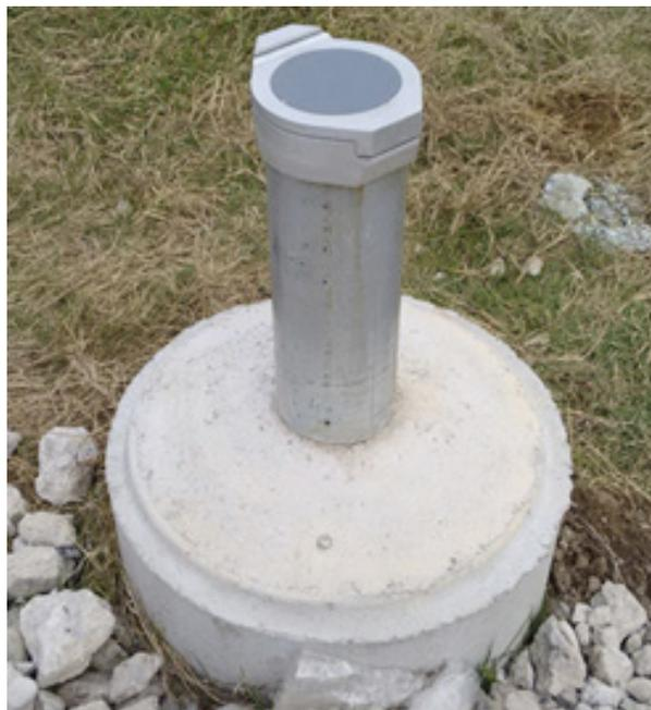
Figura 7 Detalhe do poço de observação.
