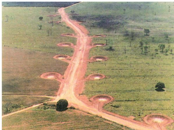
**Figura 58** Estrada protegida por bacias de captação de águas pluviais construídas nos dois lados da estrada acopladas a sistema de terraceamento.
