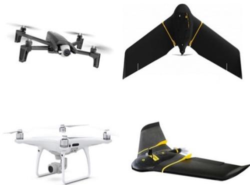
**Figura 3** Exemplos de VANTs com propulsão elétrica, divididos nas categorias asa-rotativa (multirrotores) e asa-fixa, conforme indicado no Projeto.
