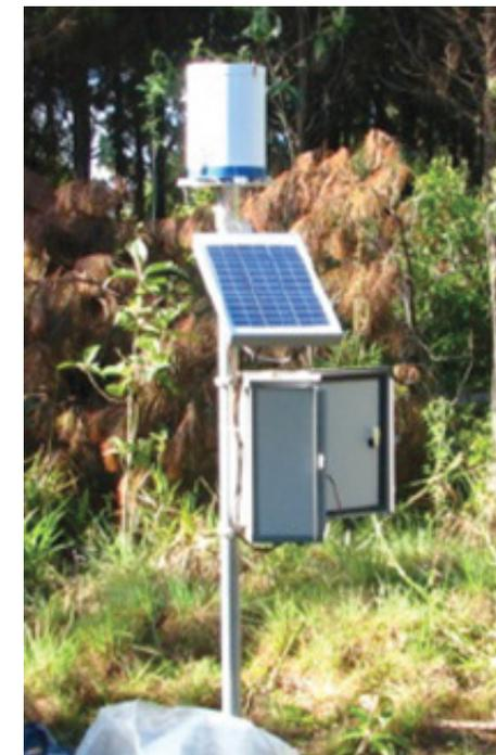
Figura 8 Plataforma de coleta de dados do pluviômetro e dos níveis de água no interior dos poços de observação e no vertedor. Fonte: Mota et al. (2017).
